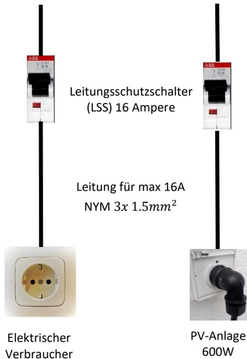
Die beste Variante ist, wenn man einen separaten Stromkreis und einen zusätzlichen LSS für die PV-Anlage vorsieht. Der Vorteil bei dieser Variante liegt darin, dass die PV-Anlage einzeln abgeschaltet werden kann.
